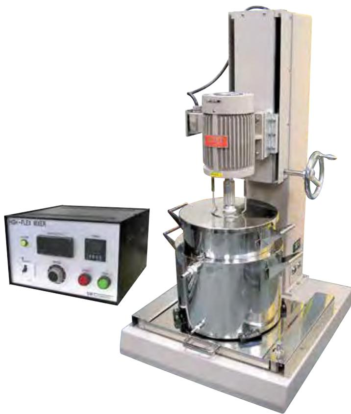
従来の20ℓミキサーを自動運転により、生産用として製作しました。ジャケット温度やサンプルの温度などを測定しながら攪拌後はオートバルブにより次の工程へと送られます。このタイプは攪拌機部を1つのボックスに収納し、防音や安全性を考慮してあります。
