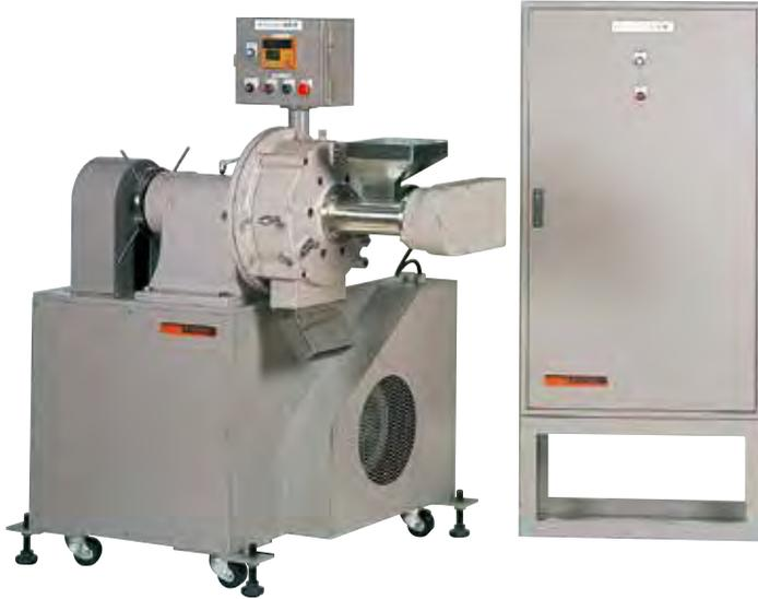
木材チップのパルプ化やパルプの調整、さらにポリオレフィン系誘導品、及び合成繊維、硝子繊維、炭素繊維のパルプ化等、各種高分子材料の繊維化、フィブリル化を簡単迅速に処理します。生産設備(実機)と同等の形状をした、リファイナプレートを用いているため最終製品と同じサンプルを作り出すことができます。また、安定した高出力22kwのモーターを搭載しておりますので、低濃度から高濃度(30%)領域まで幅広い範囲でご使用頂けます。原料の挿入は、インバーター制御による無段変速方式を採用し、送り速度はデジタル表示されます。
