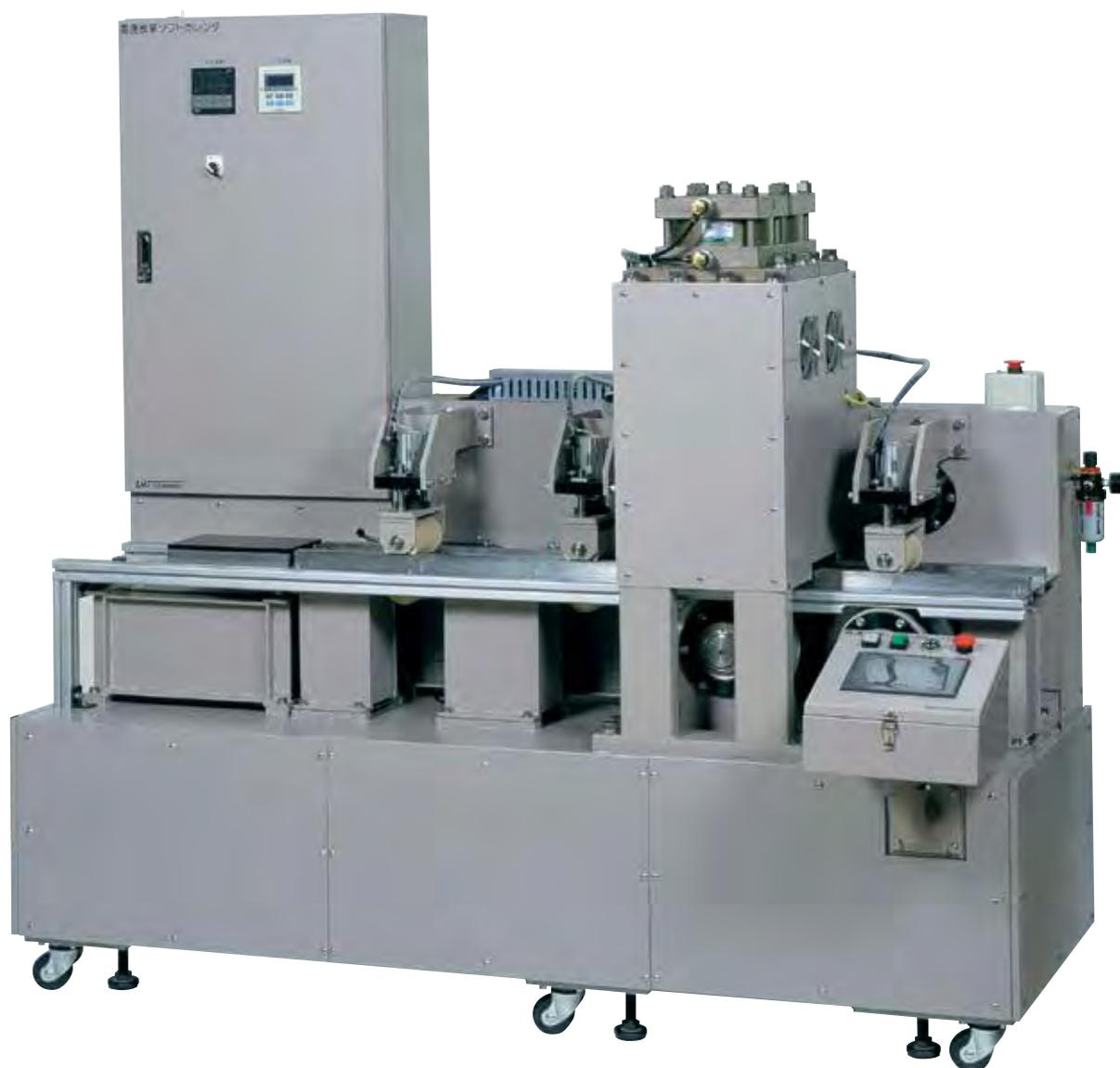
製紙関連業界で使用されるコーティングカラーの分散、その他の湿式混合・攪拌・分散を短時間で均一に処理する事を目的とした試験、研究用小型高速攪拌装置です。制御装置は、インバーター方式によるPWM周波数可変方式を採用しており、タッチパネルの操作により回転数、運転時間はもとより加速時間、ステップ運転時間の回転数などの設定ができます。攪拌シャフトは簡単に着脱できるので、洗浄などが非常に簡単な事、また攪拌タンク内のインペラーの上下位置、攪拌ペラの種類が変更されるため、様々な条件に対応し試作することができます。常に同一条件の運転で攪拌が可能のため、様々なサンプルに対応し目的にあったサンプルの試作が可能です。
