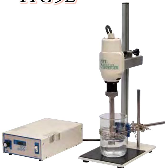
小型高周波（高速）モーターを採用したディスペンサーです。火花・粉塵の心配がなく、安心してお使いいただけます。シャフトの選択によりインペラー形式のホモジナイザーでは難しい、繊維質等のサンプルの破碎が可能です。インバーターによる自動制御方式なので、幅広い回転数で力強い攪拌が行えます。
