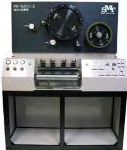
本機はオフセット印刷機の印刷版に乳化したインキを転写し、その時の供給した水分値とインキ量によって版面の汚れを作り出し裏取りを行い、オフセット印刷用のインキの特性を評価するための印刷機です。予め温度管理された版胴に水無しインキ用PS版を貼付け、インキ練りユニットでインキを転写したディスクロールを軸に装着し、版胴とディスクを一定圧力でニップし、設定した印刷速度、印刷回数のもと、PS版にインキを印刷させます。更に、PS版に印刷されたインキを圧胴に貼られた転写用紙に裏取りを行い、水無しインキとPS版の評価をすることが出来ます。
