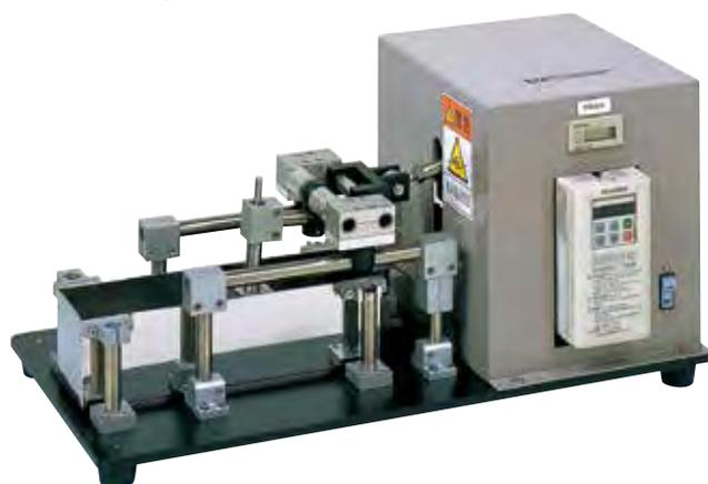
オフセット版 (PS版) とブランケットの間にインキを塗布し、繰り返しこすれを与え、オフセット版の耐久性、インキがオフセット版に与える耐摩耗性を評価することを目的として開発されました。オフセット版 (PS版) のみならず、ブランケットの耐摩耗性、インキ流動性も同時に評価することができます。
