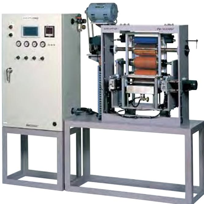
近年、商業用オフセット印刷機、特にオフ輪印刷機(オフセット輪転印刷機)の印刷速度の高速化に伴い、インキロールから発生するインキミストが印刷物に対し、クレームとなっております。ミスチング試験機は、高速インキ練り装置として、実験的にインキミストを発生させる目的で考案されました。インキ開発、製品の管理でインキミストの発生状況の把握、インキミストの発生を抑える製品の開発に十分、お役に立てる試験機です。
