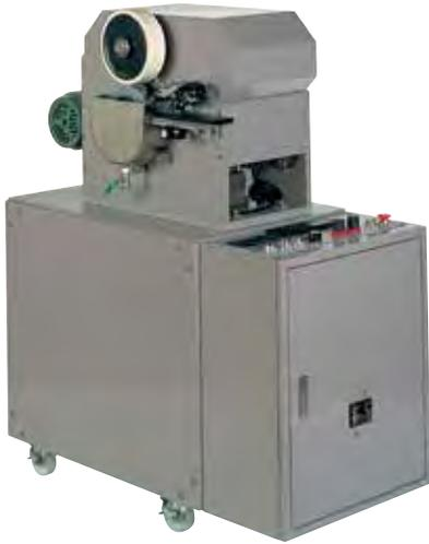
グラビア印刷の指標となる印刷圧力、印刷速度、ドクターブレード条件を自由に設定でき、従来の試験装置では困難であった試験機としての再現性、信頼性を高めた試験機です。インキ槽で版胴に着肉したインキをブレードにて掻き取り、試験片を巻き付けた圧胴と接触する事により、一定の印圧で試験片にインキが転写され印刷が終了します。また、従来の試験装置は試験終了後の洗浄が、インキ漏れなどにより非常に手間がかかりましたが、この装置はインキ槽のシール化など作業性も考慮した装置です。
