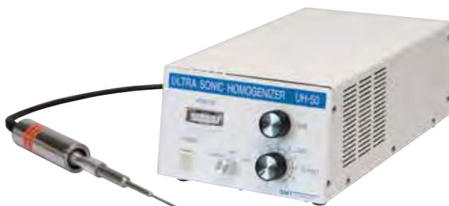
小型軽量かつ50Wながら最大振幅40 $\mu$ mの強力な超音波を発生します。ハンドパルサー(手元スイッチ付)のため、発振器の操作なしで超音波の発振・停止が行えます。また、サンプルの負荷変動や圧力の変化などの条件変化にも対応し、常に一定の振幅を確保できます。主に、微粒遠心機用のマイクロチューブ、マイクロプレート、試験管等の容器中のサンプル処理に適しています。
