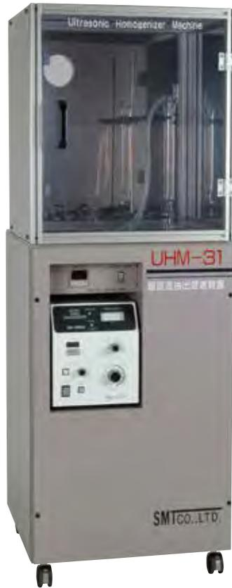
洗浄・分散・乳化において優れた性能を発揮する超音波の原理を応用し、抽出効率を大幅に促進する事が可能となりました。特にダイオキシン類の抽出における溶媒抽出でも、安全にお使い頂ける様に工夫されております。
