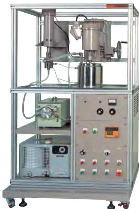
高速ミキサーと超音波分散機を一体化し、2段階の分散を1台で連続的に行える装置です。処理液は高速ミキサー内で予備分散され、超音波分散部へとチューブポンプで送り込まれます。高速ミキサーと超音波分散機を循環した処理液は、着脱式タンクによって容易に次工程へと送ることができます。
