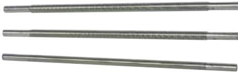
ステンレス製の丸棒を研磨加工し、規定のステンレスワイヤーを巻き付けたものです。コーティングを基材にした塗料が巻き付けられたステンレスワイヤーの間に残り、それが紙、ブリキ、ゴムなどの各種板に転移して一定の厚みに塗布されます。インキ、ペイント、ワックス、その他のエマルジョン、カゼイン、ゼラチン、接着剤、プラスチック及び多くの材料を塗布するにあたり最適です。
